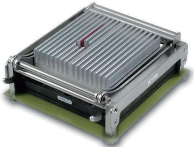
ES 系列插座扩展了老化测试插座的应用范围。其模块化盖体结构能够承受高达 1 千瓦的功率,并通过热模拟方式进行了优化,以确保无论在液冷还是风冷的条件下,都能具备开箱即用的卓越性能。
